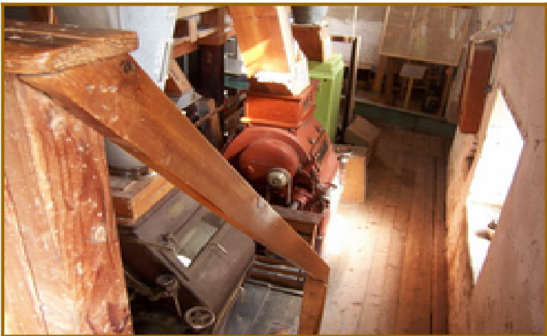
Abb. In diesen Walzenstühlen im Zwischengeschoss wurde das Getreide gemahlen
