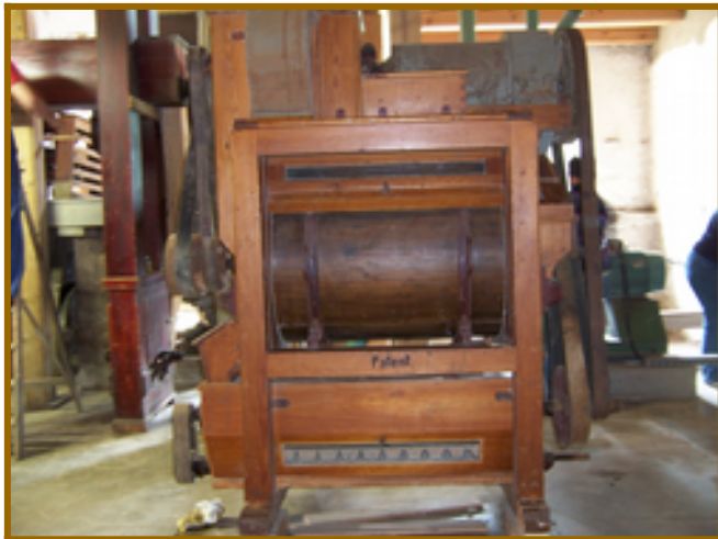
Abb. Gerätekombination Trieur, Schälmaschine und Bürstmaschine im Erdgeschoss
