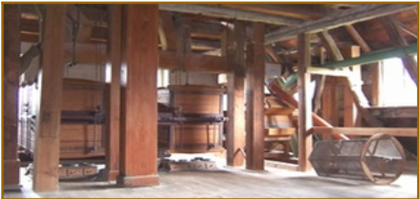
Abb. Im 3. Obergeschoss von links zu sehen Plansichter oder Sichtmaschine, rechts hinten daneben ein Aspirateur und vorn ein Siebteil eines früher in Mühlen verwendeten Sechskantsichters
